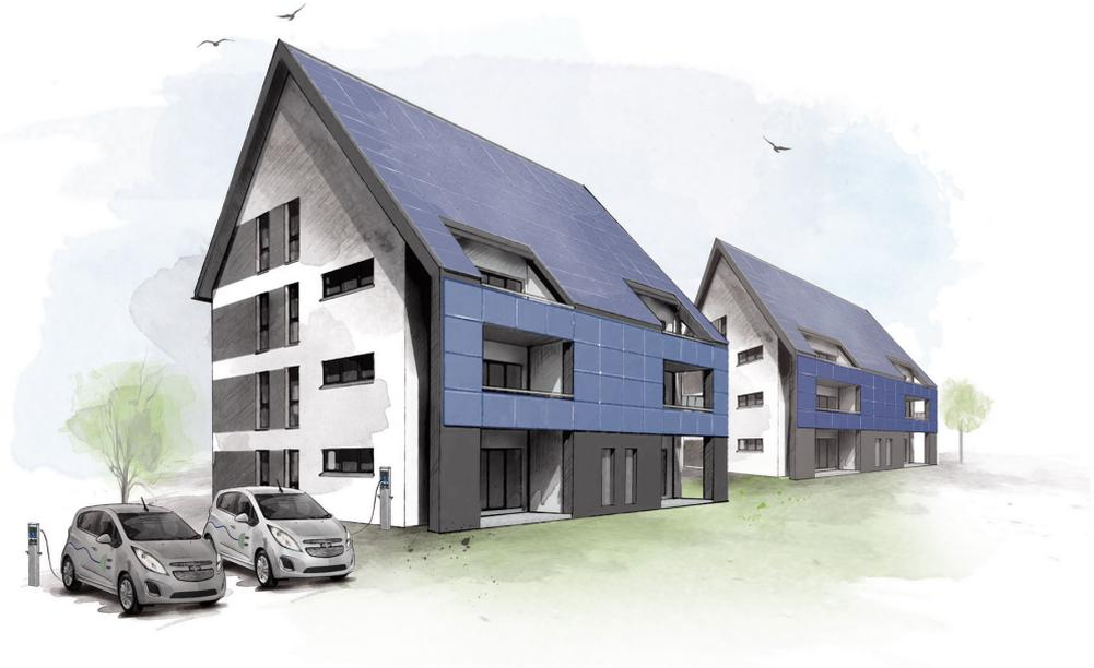
↗ **Abb. 13:** Das Modell überzeugt. In Cottbus: Zwei vermietete energieautarke Mehrfamilienhäuser mit je 7 Wohneinheiten, Baujahr 2018. Eine solare Deckung zwischen 65 und 77 Prozent für Strom und Wärme. Auch hier mieten die Bewohner die Wohnungen im Rahmen einer Pauschalrente, die Wohnen, Wärme und Strom als Flatrate enthält.
