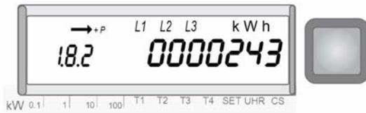
Die Anzeige wechselt automatisch zwischen 1.8.1 (T1) und 1.8.2 (T2) (Intervall 15 Sek.)
