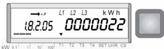
Durch Antippen der **Anzeigetaste** wird der Anzeigecode um 2 Stellen erweitert.
